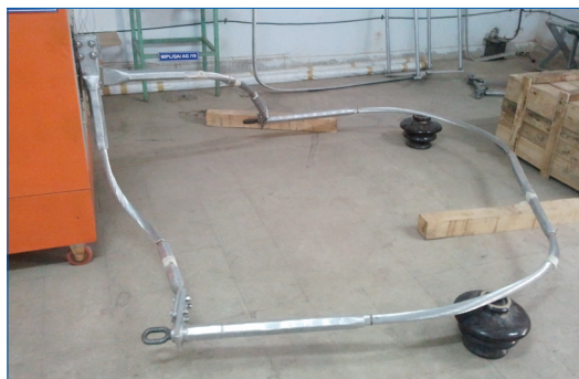
Alterungsversuch mit Pressabspannklemmen für Hochtemperaturseile
