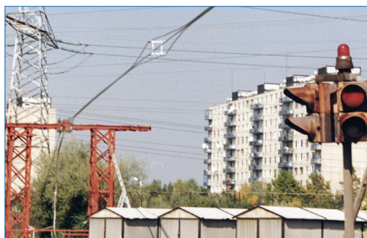
Kurzschlussversuch mit dämpfenden Feldabstandhaltern
