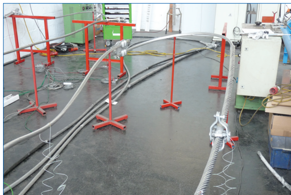
Alterungsversuch mit Hängeklemmen für Hochtemperaturseil
