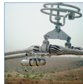
Schwingungsmessung mit Recorder an einer LTS-Klemme
